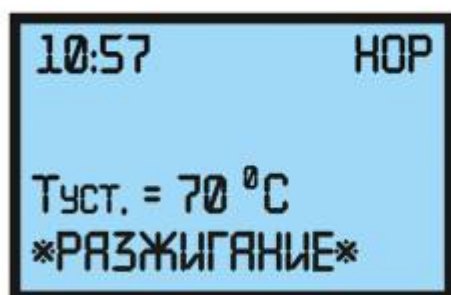
Рисунок 12 – Вид панели управления в режиме РАЗЖИГАНИЕ
